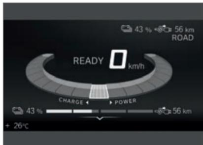
L'E-Scooter est mis en état de fonctionnement en appuyant sur la touche de démarrage et en actionnant le frein. L'affichage de l'entraînement apparaît et **READY** est affiché. Tous les systèmes sont opérationnels. Si le coupe-circuit est activé, l'E-Scooter n'est plus en état de fonctionnement.
