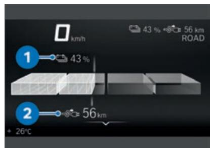
Si le véhicule n'est pas prêt pour la conduite, la vue Pure Ride à l'écran est remplacée par la vue Pure. Le niveau de charge de la batterie **1** et l'autonomie **2** sont affichés.
