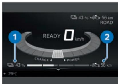
L'autonomie **2** indique la distance pouvant encore être parcourue avec le niveau de charge actuel de la batterie **1**.
