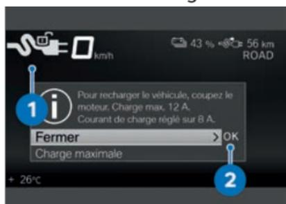
Si le contact de disponibilité est mis, l'avis 2 apparaît. Le symbole 1 signifie que le câble de recharge est raccordé mais que la charge n'a pas encore commencé. Vous pouvez sélectionner une limitation du courant de charge ou lancer direc-
